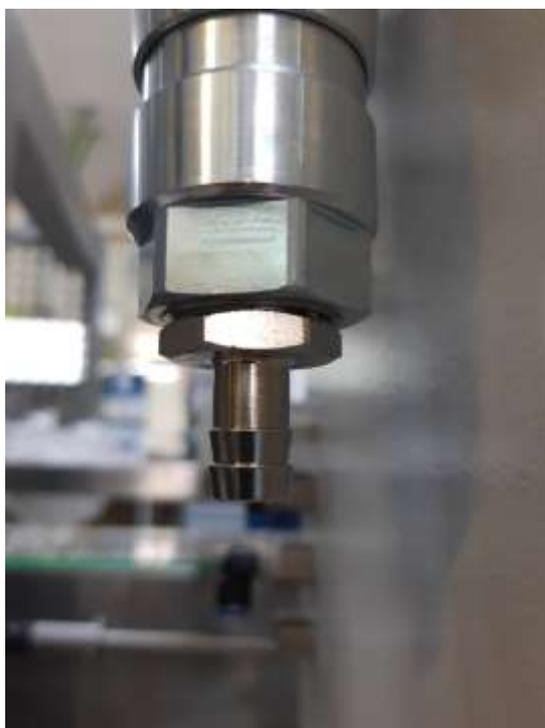
Для подключения сжатого воздуха применяются быстроразъёмные пневматические соединения. Проходное сечение подбирается в соответствии с расходом воздуха.
