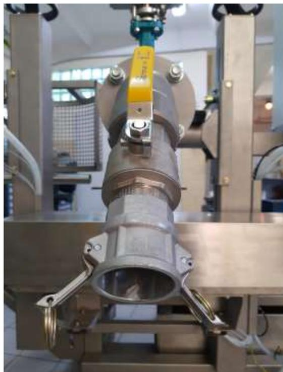
Для подачи фасуемого продукта применяются Camlock (Cam & Groove) быстроразъёмные соединения из алюминия или нержавеющей стали различных типоразмеров. Наиболее популярные 2 и 3 дюйма.
